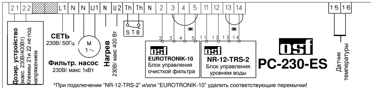
При подключении устройства тепловой защиты необходимо удалить перемычку между контактами *Th*. Если защита не используется перемычку необходимо прикрутить.
